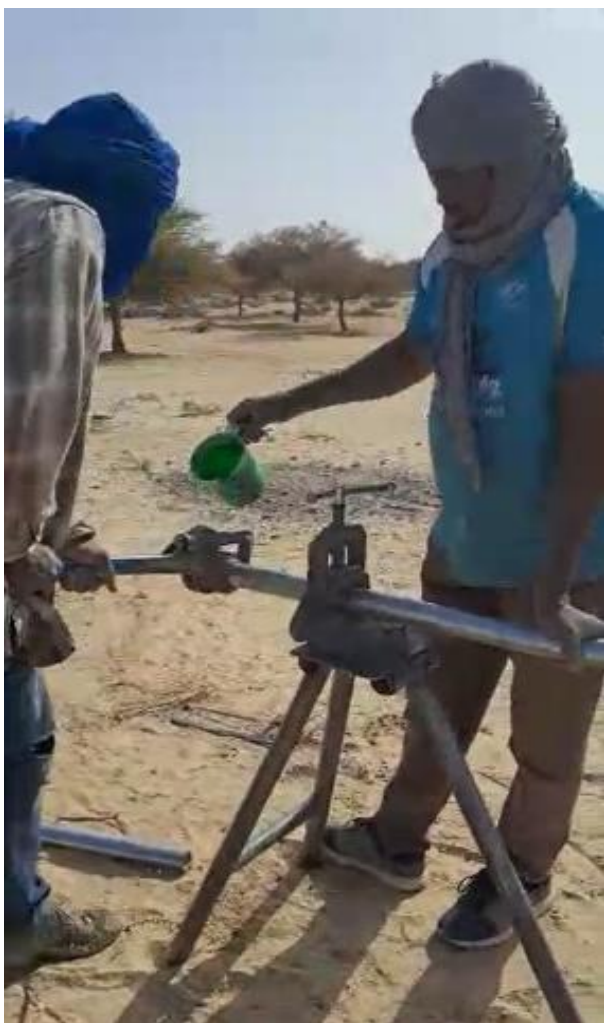
De schroefdraden worden met de hand gedraaid
